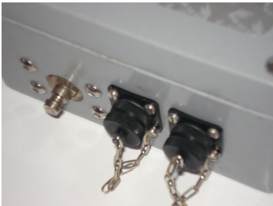
O *Scorpion 25 PF®* possui dois conectores militares na parte lateral da caixa. O conector de 4 pinos é usado para aquisição de dados através da comunicação serial RS 232. O outro conector, de 8 vias, é usado na medição de vazão. A vazão é aferida através da contagem de tempo entre pulsos consecutivos em contato seco dos pinos C e D do conector de 8 pinos. O segundo grupo de comunicação é composto por um pino para engate rápido que tem a função de coletar a pressão.
